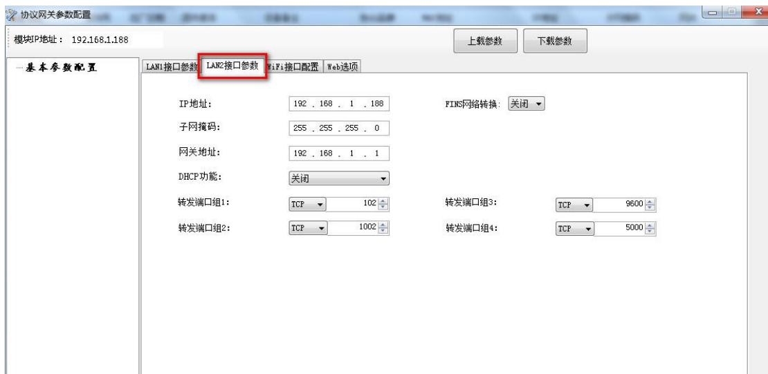
**IP 地址**、**子网掩码**、**网关地址**分别为 RVNet-NAT-S 的 LAN2 接口的 IP 地址、子网掩码、网关。
