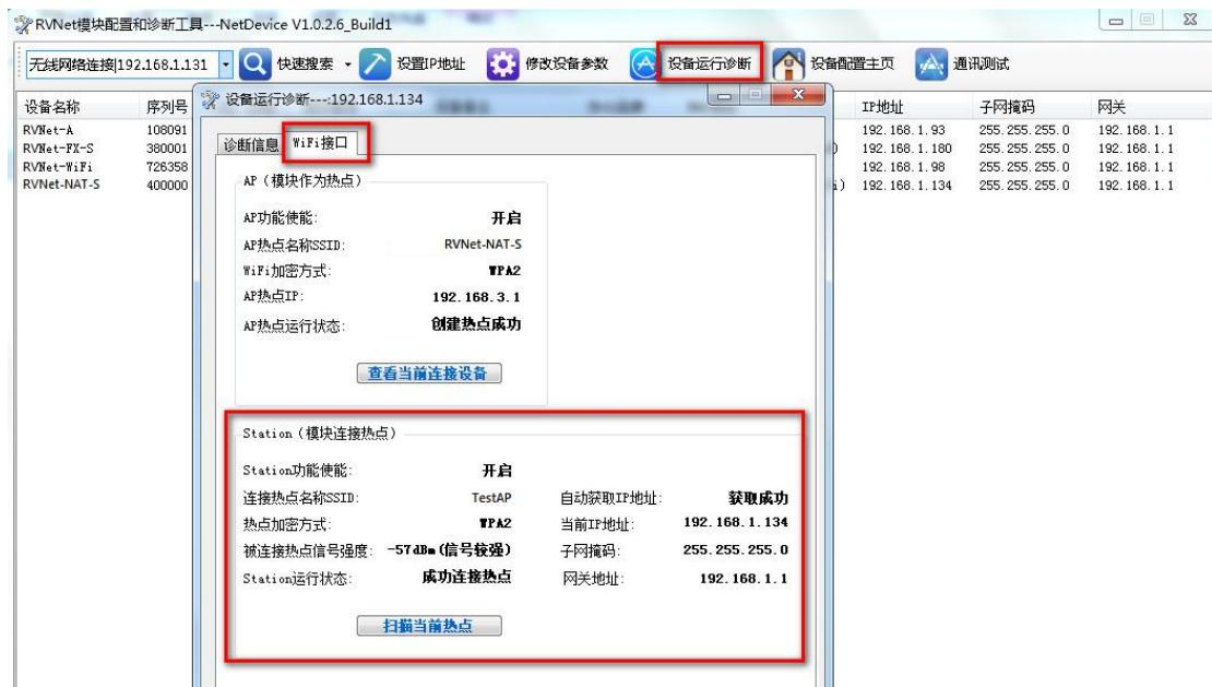
此时通过 NetDevice 可对模块进行参数配置和诊断，上图表述了“设备运行诊断”界面下，“WiFi 接口状态”>“Station(模块连接热点)”，可以看到 Station 的运行状态为“成功连接热点”，且连接的热点信号强度为“-57dBm(信号强)”，当前 IP 地址为“192.168.1.134”；
