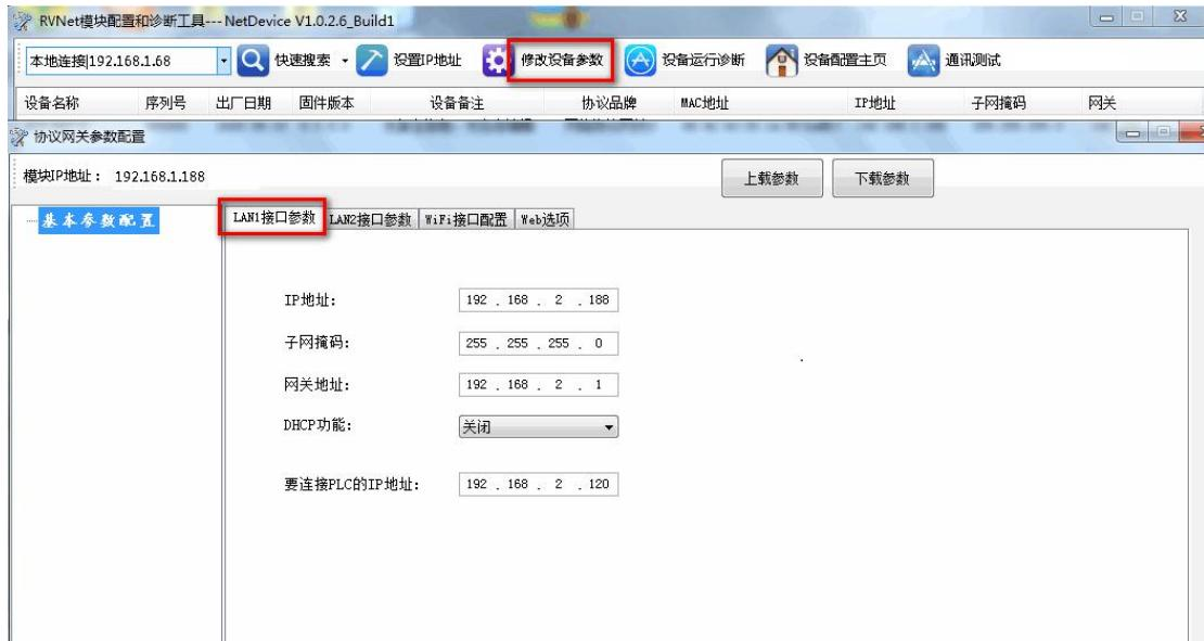
**IP 地址、子网掩码、网关地址**分别为 RVNet-NAT-S 的 LAN1 接口的 IP 地址、子网掩码、网关。
