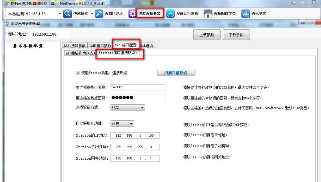
**使能 Station 功能:** 使能 Station 功能，连接热点；
