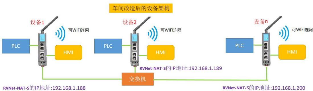
在不改变原系统（PLC和HMI）设置的情况下，通过RVNet-NAT-S的NAT地址转换，可实现设备联网的方案需求。
