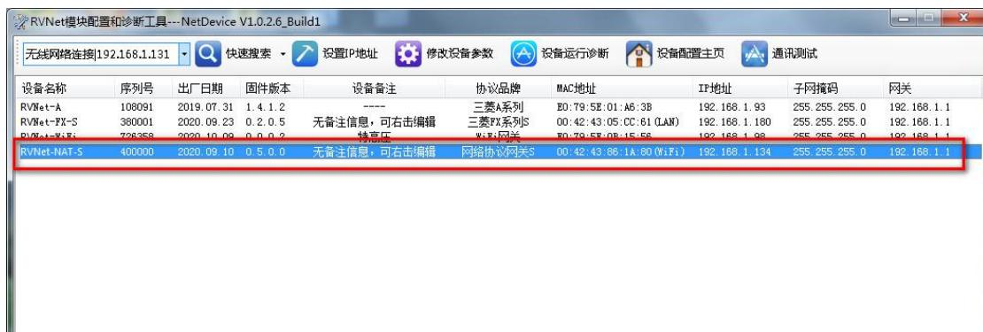
如图所示，搜到同一设备会显示(LAN)和(WiFi)两个网络接口，(WiFi)即为模块作为 Station 模式下，连接 AP 热点后，获取到的 IP 地址，对该 IP 地址操作，即可实现数据采集、PLC 编程和数据交换；
