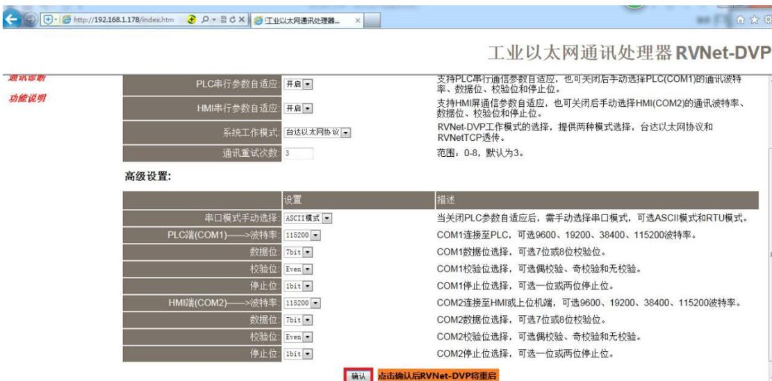
PLC 串行参数自适应：默认为“开启”，“开启”状态下不需要再去设置“串口模式手动选择”、“PLC 端 (COM1)——>波特率、数据位、校验位、停止位”，将自动识别 PLC 的串口模式、波特率、数据位、校验
