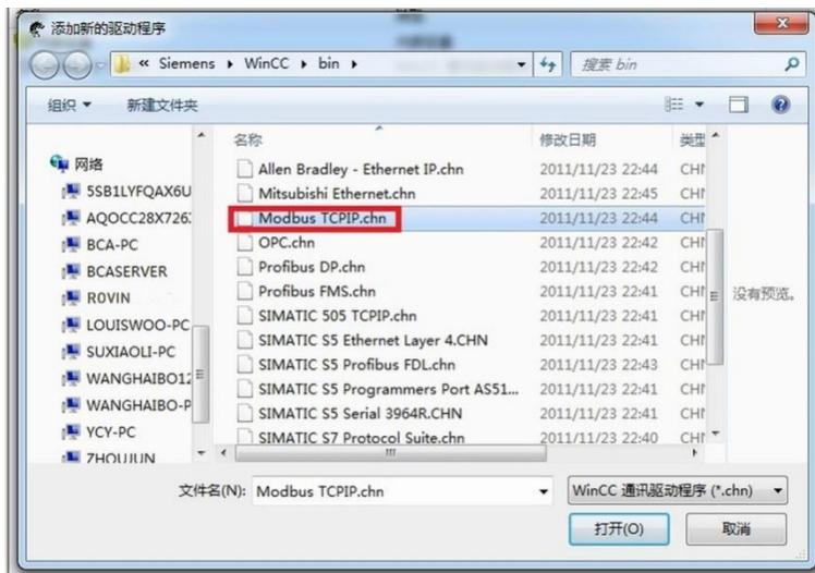
2.右击“Modbus TCPIP/IP 单元#1”选择“新驱动程序的连接”，新建一个名称，点击“属性”，弹出属性的对话框，在“CPU 类型”选择“984”，在“服务器”中填入 RVNet-DVP 的 IP 地址，“端口”默认为 502，“远程从站的地址”处填入 PLC 编程口的站地址，默认为 1，点击确定。
