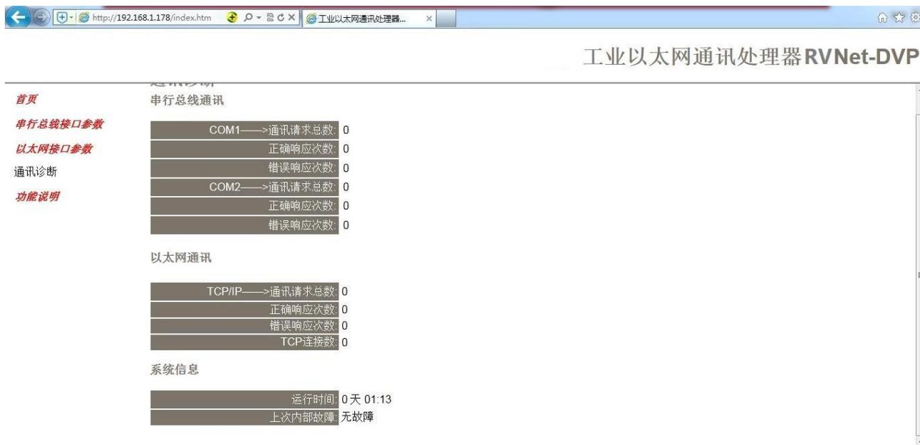
**COM1—通讯请求总数：**所有发送到 PLC 的通讯请求数目；
