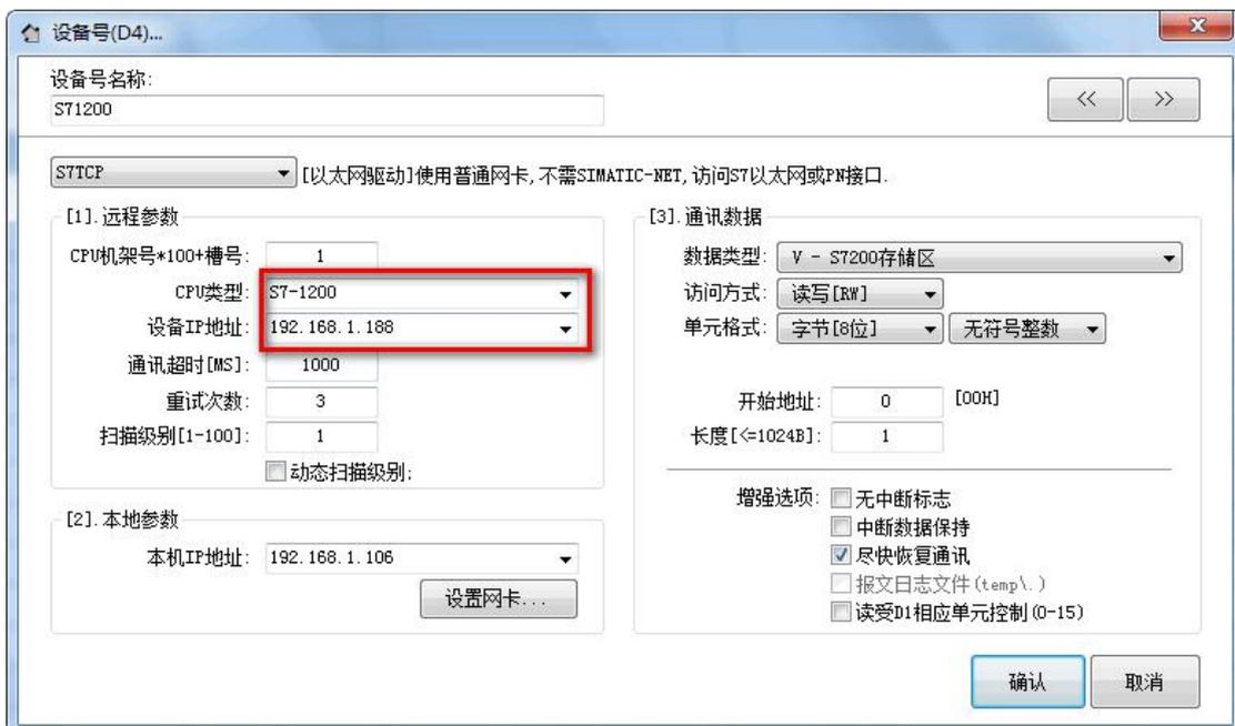
【CPU 类型】选择 S7-1200，【设备 IP 地址】填入 RVNet-PN 的 IP 地址；
