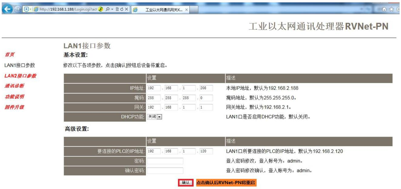
设置 RVNet-PN 的 LAN1 接口的 IP 地址、掩码和网关（即路由器的地址）；
