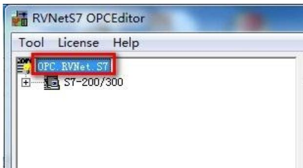
2、点击【New Connection】，在如下窗口填写连接设备的名称，如：S7-200/300，输入 RVNet-PN 的 IP 地址，【S7 PLC Address】填入默认值 2；
