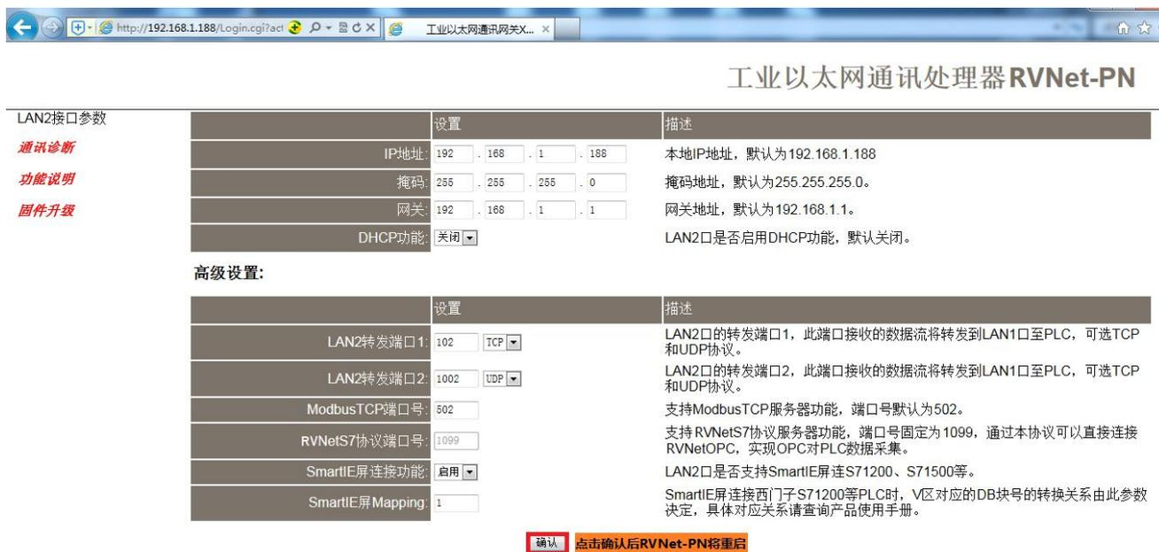
设置 RVNet-PN 的 LAN2 接口的 IP 地址、掩码和网关（即路由器的地址）；LAN2 接口的 IP 地址与连接的 PLC 的 IP 地址不一定要在同一网段（IP 地址可设置为其他网段）。
