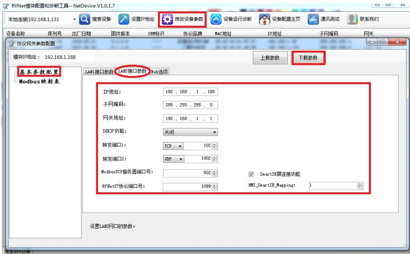
IP 地址、子网掩码、网关地址分别为 RVNet 的 LAN2 接口的 ip 地址、子网掩码、网关。LAN2 接口的 IP 地址与连接的 PLC 的 IP 地址不一定要在同一网段（IP 地址可设置为其他网段）。
