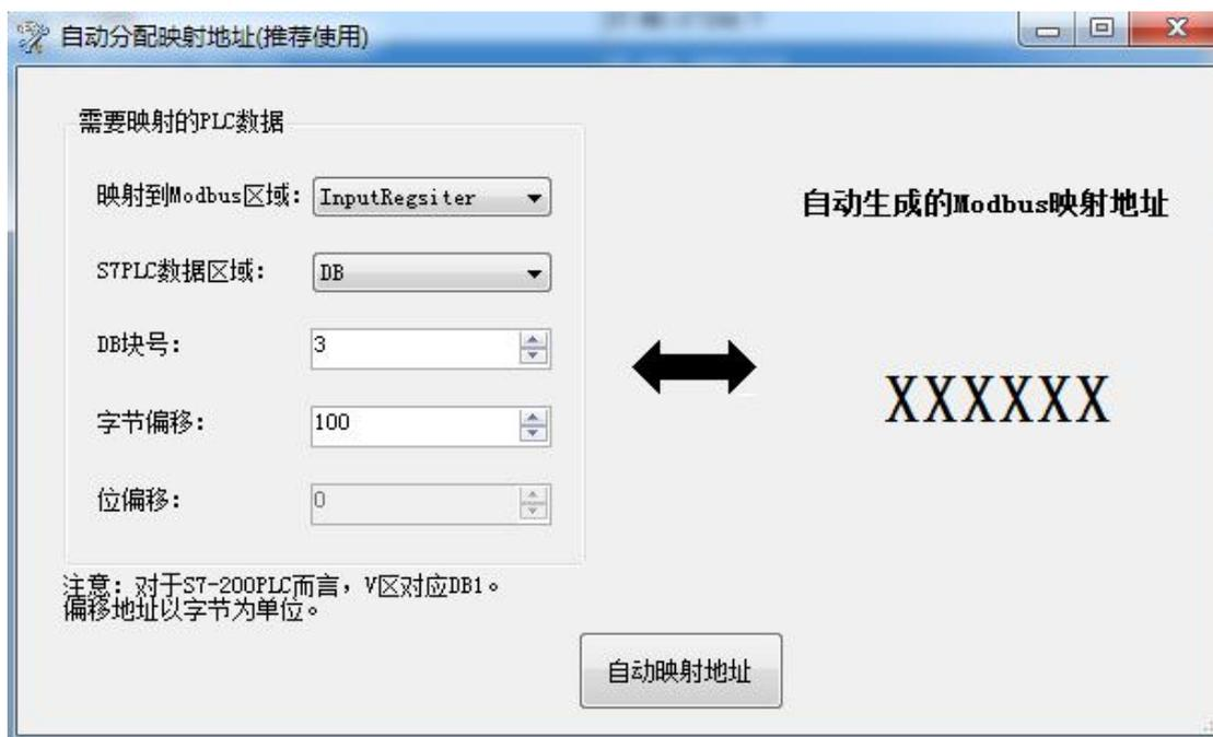
4) 映射表编辑完成后，可以通过地址查询确定对应关系，比如要查询 DB1.DBW0 对应的 modbus 地址：点击【映射地址查询】，按如下设置，点击【查询】按钮，可以查询到对应的 Modbus 映射地址。
