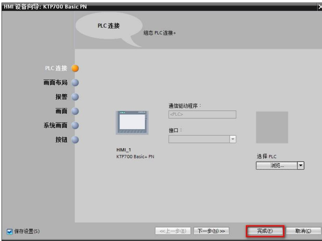
3、给触摸屏分配 IP 地址（必须和 RVNet 模块的 IP 地址在同一网段）；
