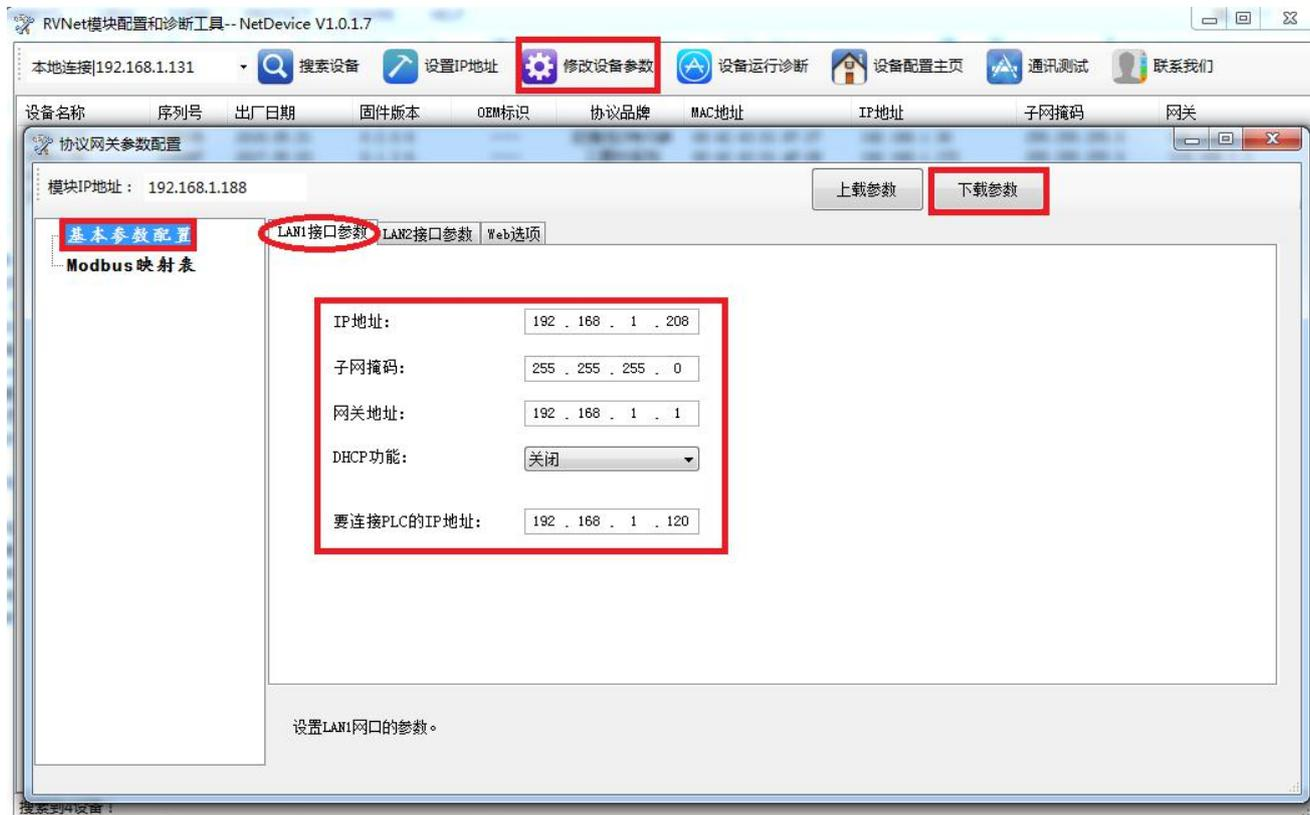
**IP 地址**、**子网掩码**、**网关地址**分别为 RVNet 的 LAN1 接口的 ip 地址、子网掩码、网关。
