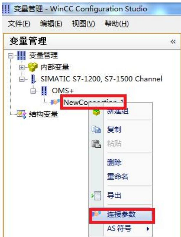
5、在弹出的对话框中，【IP 地址】填入 RVNet-PN 的 IP 地址，【访问点】选择 S7ONLINE，产品系列选择相应 PLC 的型号系列，例如 S7 1200。
