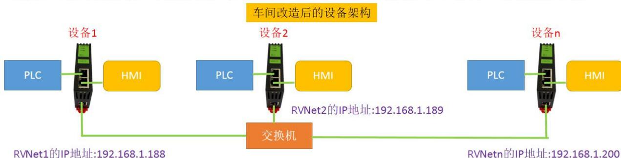
在不改变原系统（PLC和HMI）设置的情况下，通过RVNet模块的NAT地址转换，可实现设备联网的方案需求。
