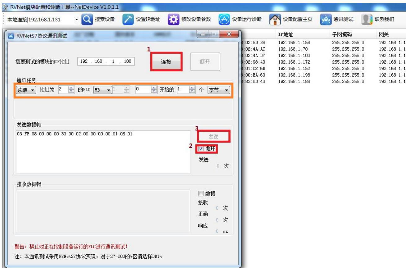
这里我们读取了 PLC 的 MB0 的数据，如果通讯正常，则会返回 MB0 的数据（最直观的方法：如果接收次数和正确次数一直是累加的话，表面通讯正常），可以借此来判断 RVNet 模块、PLC、上位机之间的以太网连接是否正常。
