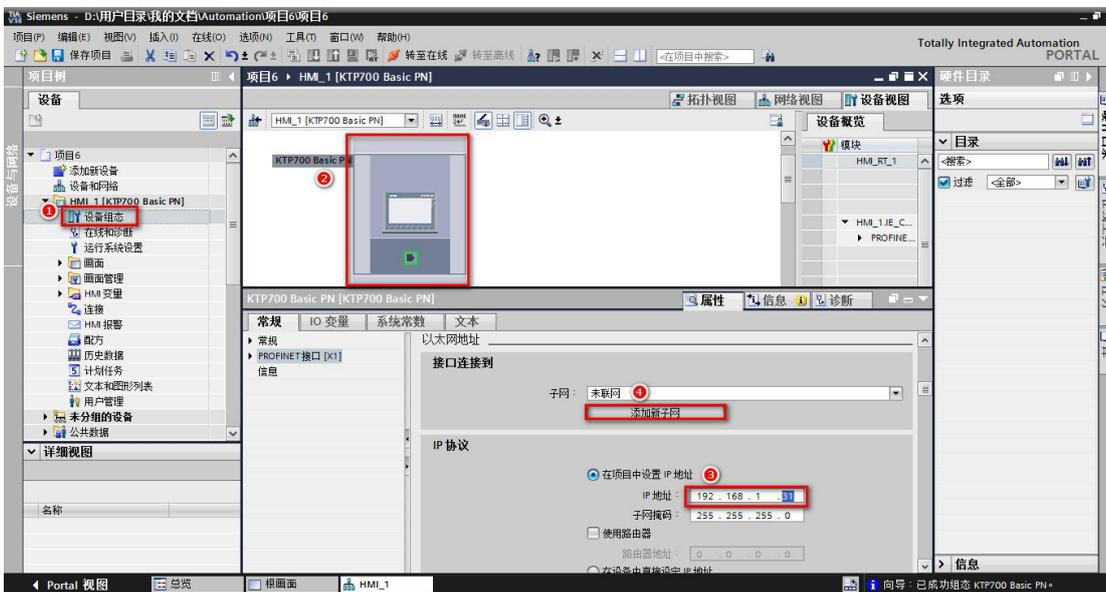
4、新建【连接】，在【通信驱动程序】中选择 SIMATIC S7 1200，在【HMI 设备】-【地址】填入触摸屏的 IP 地址，在【PLC】-【地址】填入 RVNet 模块的 IP 地址。
